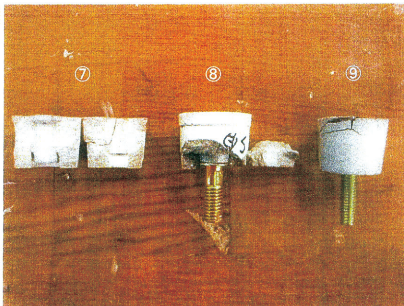
写真4 衝撃試験後の試験体状況 [落下高さ50cm試験後]
