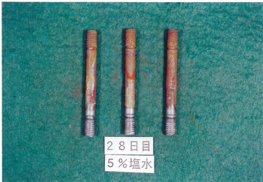
写真-6 28日後の外観状況
