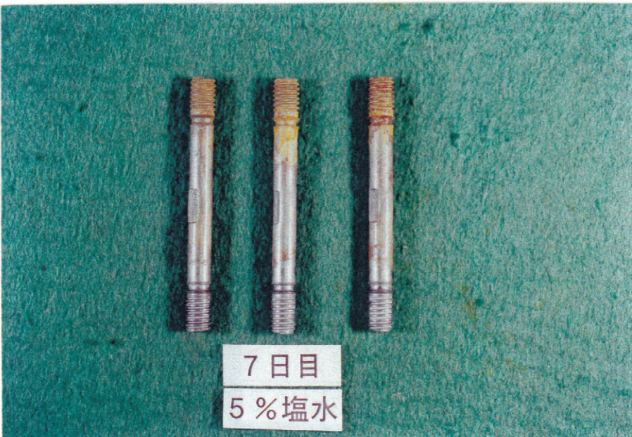
写真-3 7日後の外観状況
