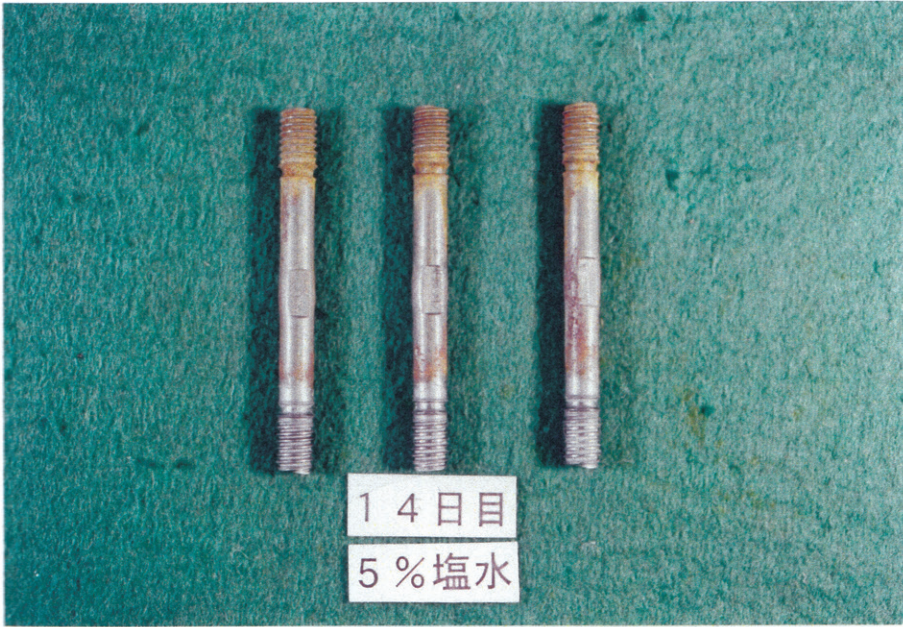
写真-4 14日後の外観状況
