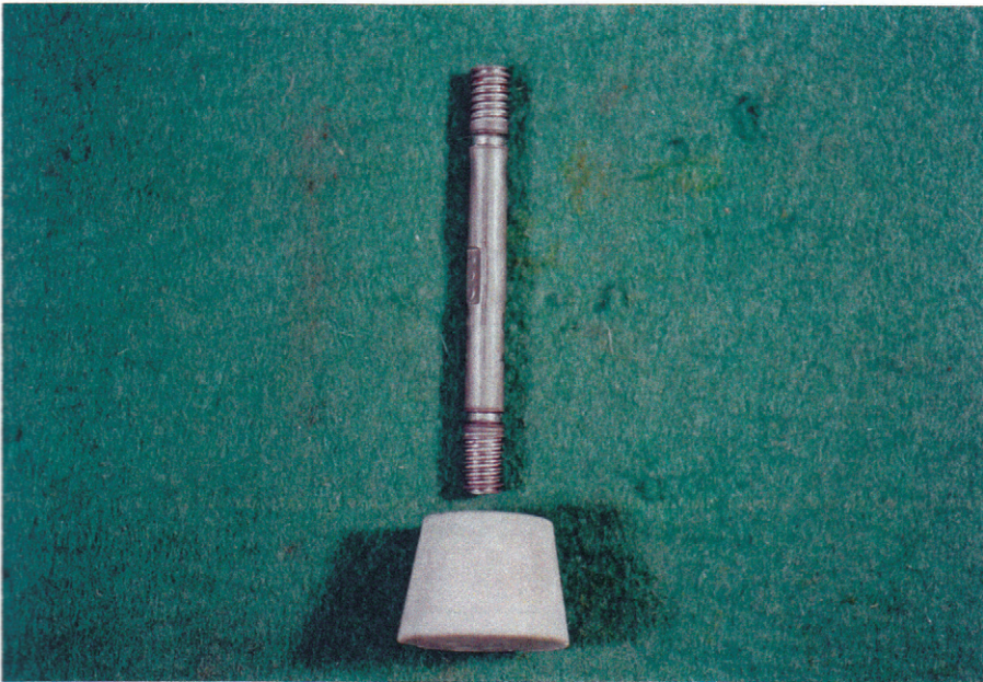
写真-2 試験体 (丸セパレーター抜き取り時)
