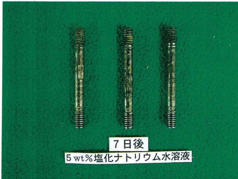
写真-3 試験体の外観状況 (7日後)
