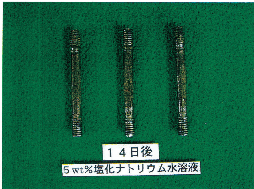
写真-4 試験体の外観状況 (14日後)
