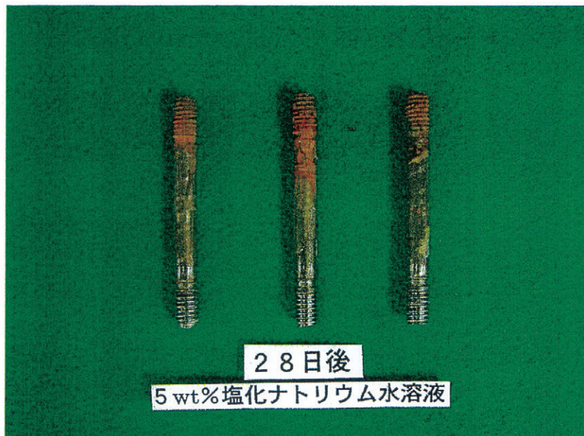
写真-6 試験体の外観状況 (28日後)
