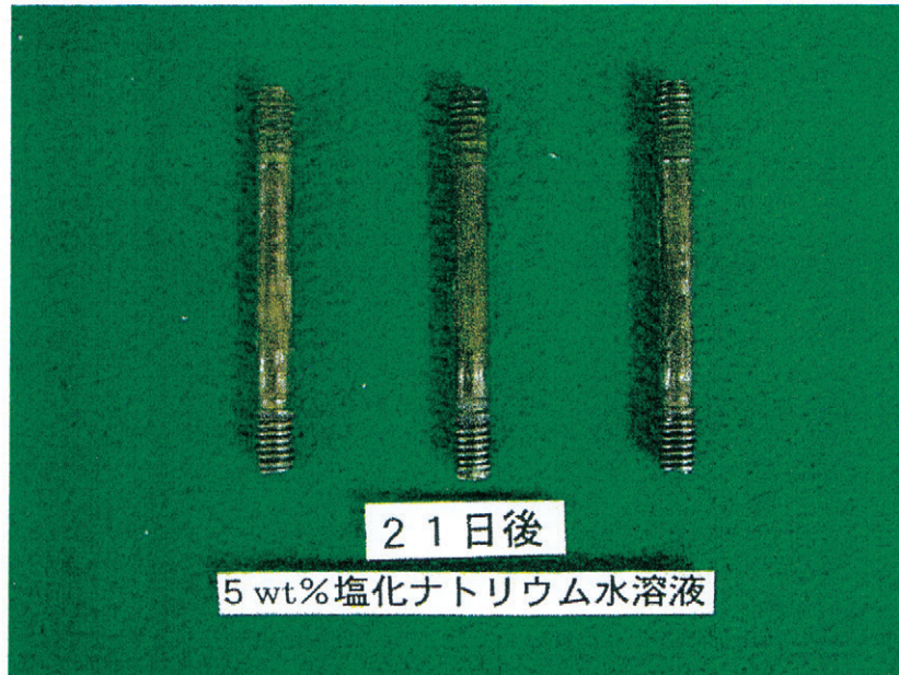
写真-5 試験体の外観状況 (21日後)
