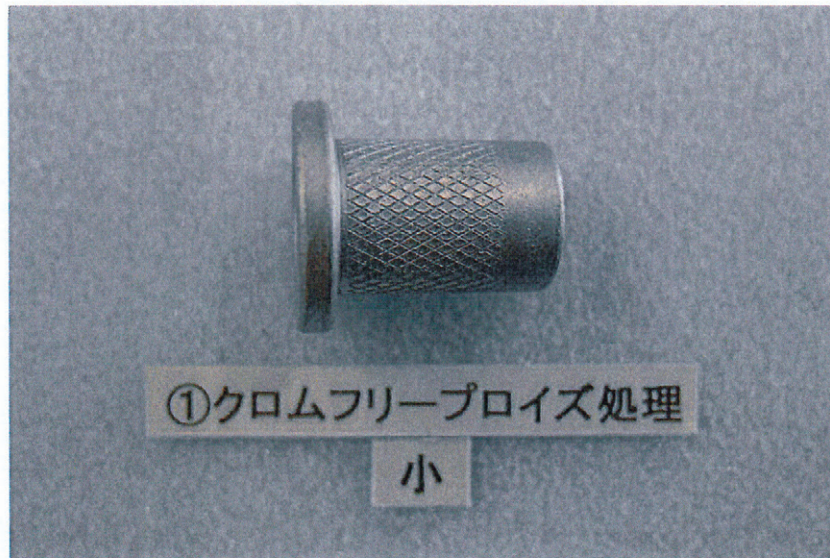
写真-2 試 験 体 (種類：小)
