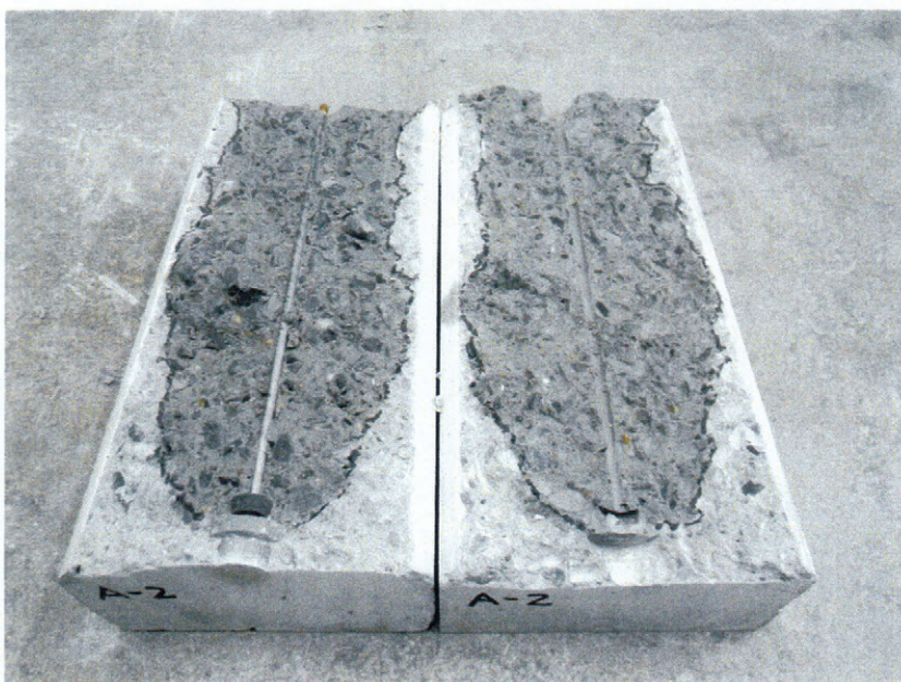
写真-5 割裂面の状況 試験体記号：A-2
