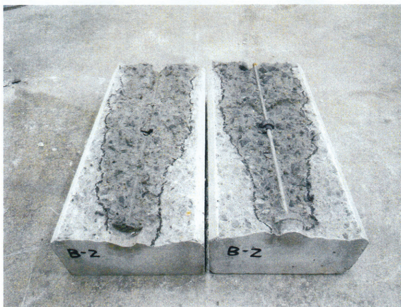
写真-7 割裂面の状況 試験体記号：B-2
