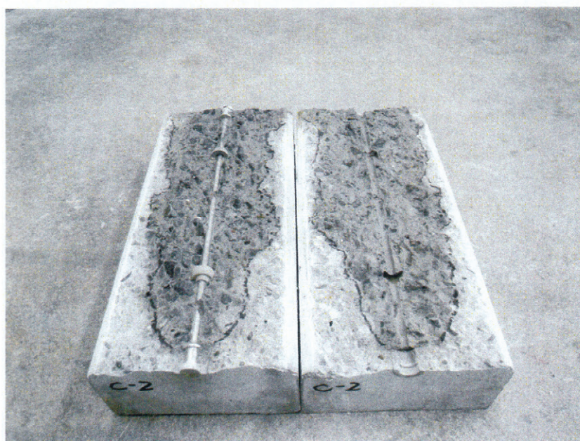
写真-9 割裂面の状況 試験体記号：C-2
