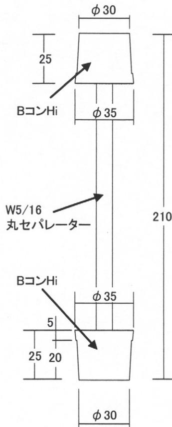
図-1 試験体の概要（依頼者提出資料による）
